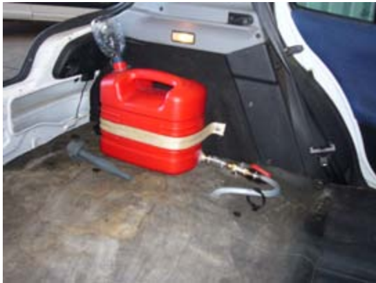
Réservoir d'eau dans le coffre de la voiture.
